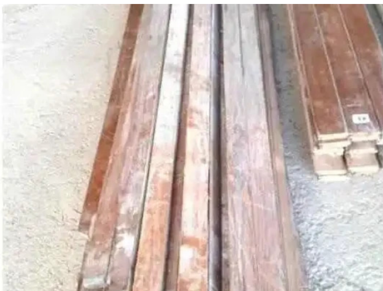
13 5 m2 de piso de pinotea 13 03 2021
