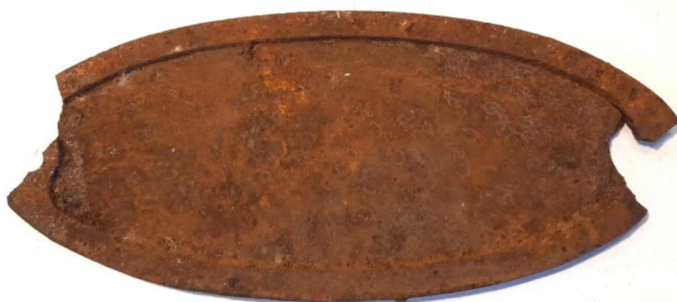
Placa en fundicion de tranvia japones 1956 con averia 05 06 2021
