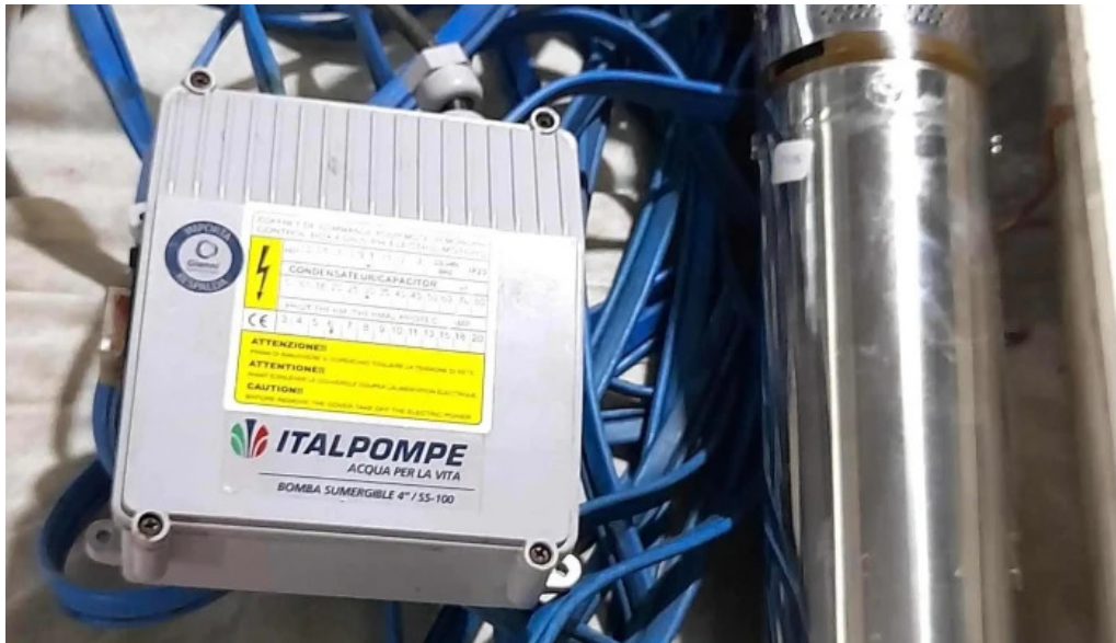
Bomba semi surgente con cable 1
